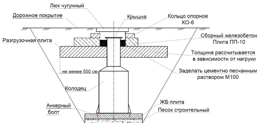
**Схема монтажа подземного оборудования при высоком уровне грунтовых вод**
