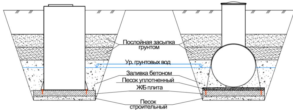
**Схема монтажа дренажных тоннелей**
