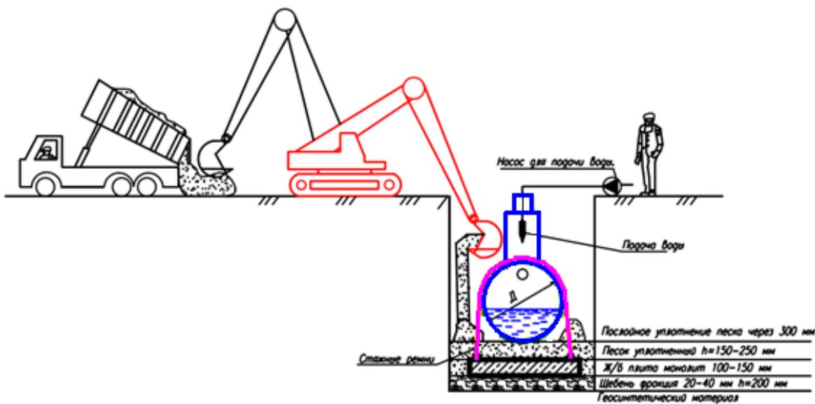
**ВНИМАНИЕ. Одновременно с обратной засыпкой необходимо производить наполнение емкостей BAZMAN водой для предотвращения её взрываия, выдавливания и смещения.**
