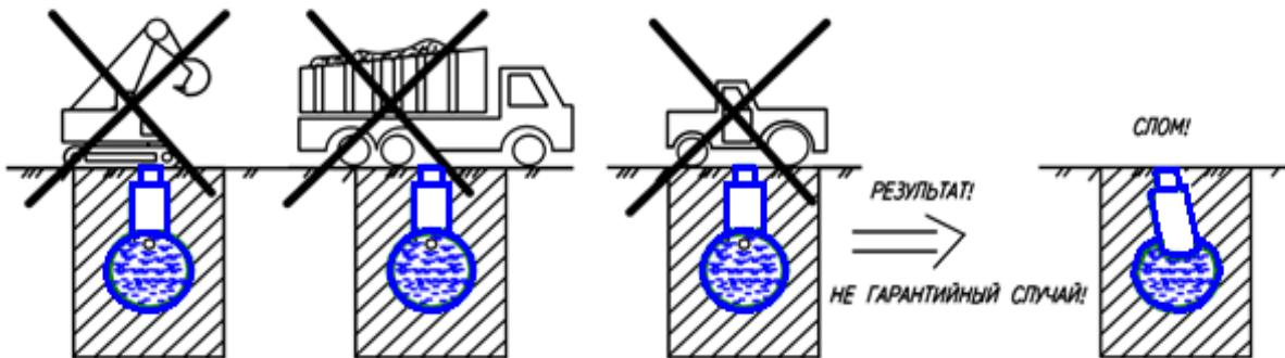
Запрещается движение автотранспорта и тяжелой строительной техники после обратной засыпки котлована с установленным в нем емкостем BAZMAN в избежание повреждений.
