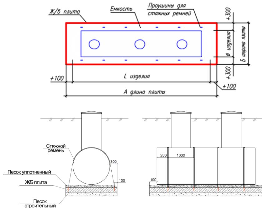
Для армирования плиты рекомендуем использовать арматуру класс AIII диаметром  $\varnothing 12$  мм с шагом 200Х200 мм. При изготовлении плиты внизу котлована достаточно армирования в одну сетку. При изготовлении плиты на бровки котлована рекомендуем армировать в две сетки в избежание поломки плиты при монтаже краном. В качестве закладных деталей (проушины для крепления стяжных ремней) использовать арматуру класс AI диаметром  $\varnothing 16$  мм.
