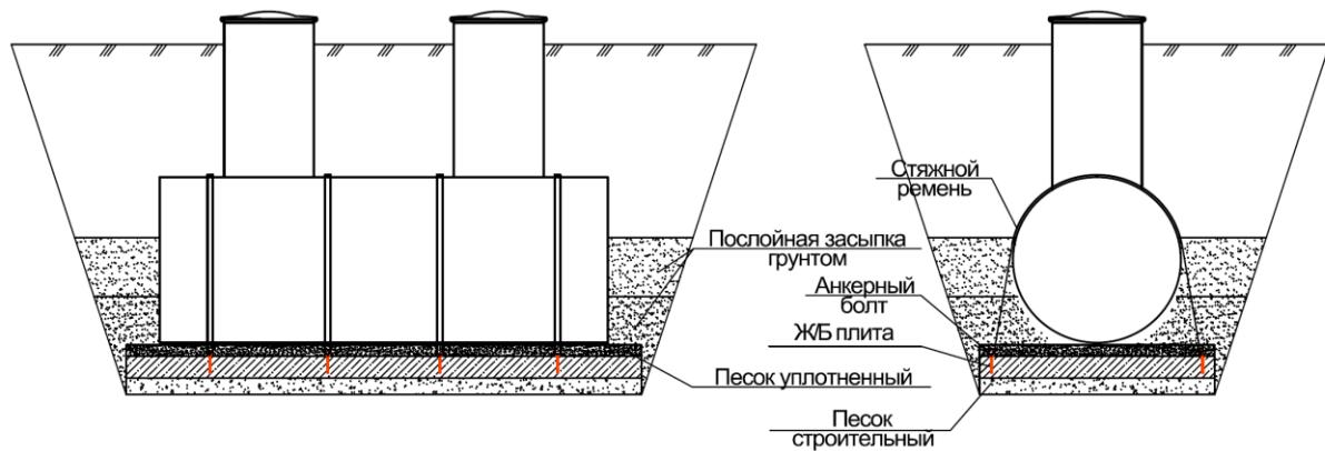
**Схема монтажа подземного вертикального оборудования под газон**
