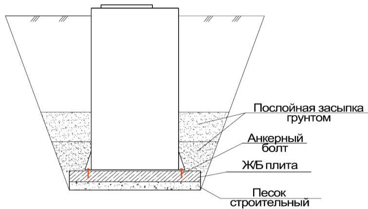
**Схема монтажа подземного оборудования под проезжую часть**
