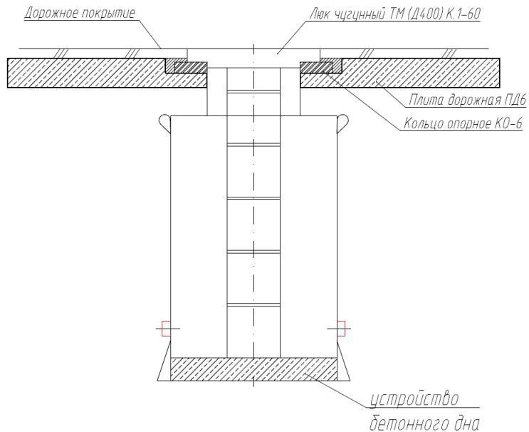
При установке емкостей BAZMAN в обводненных грунтах, при не достаточной высоте обратной засыпки или расположении в низинах и т. д. могут быть использованы следующая схема устройства пригруза,, предотвращающие всплытие.
