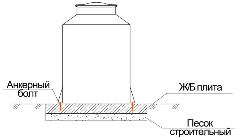
**Схема монтажа наземного оборудования на раме**
