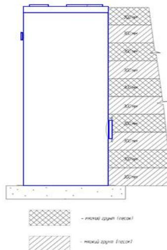
Когда обратная засыпка дойдет до патрубков, осуществить необходимые соединения и продолжать заполнять котлован слоями по 300 мм до проектного
