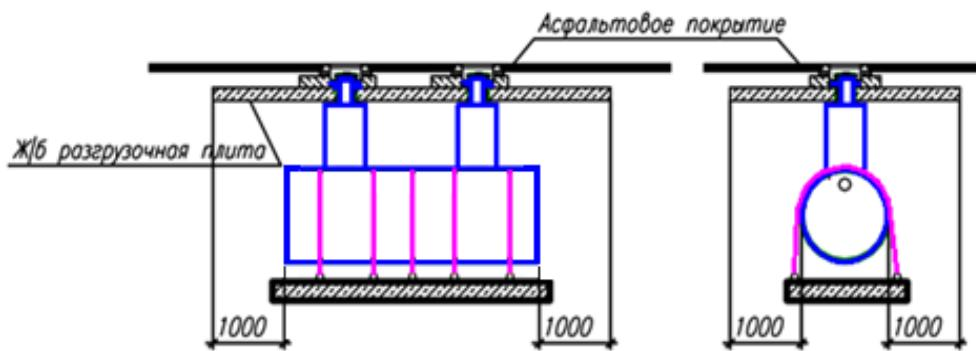
**Схема №1 Детализировка узла установки чугунных люков.**
