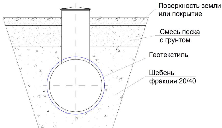
**Схема монтажа ливневых очистных сооружений в прямоугольной корпуре**
