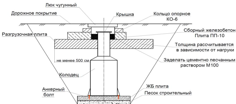
Колодцы и емкости (резервуары) из полимерных материалов необходимо монтировать на уплотненное песчаное либо монолитное железобетонное основание. В зеленой зоне, в сухих грунтах толщина песчаного основания должна быть не менее 250 мм для емкостей и не менее 150 мм для колодцев. Степень уплотнения песчаного основания должна быть не ниже 0,95.
